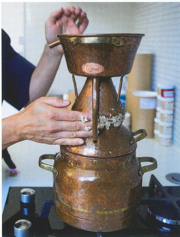
Les fleurs sont coupées et plongées dans l'eau. L'ensemble est placé dans la petite cuve du vieil alambic. La pression va permettre la distillation : quand ça chauffe, l'huile essentielle sort goutte à goutte.
